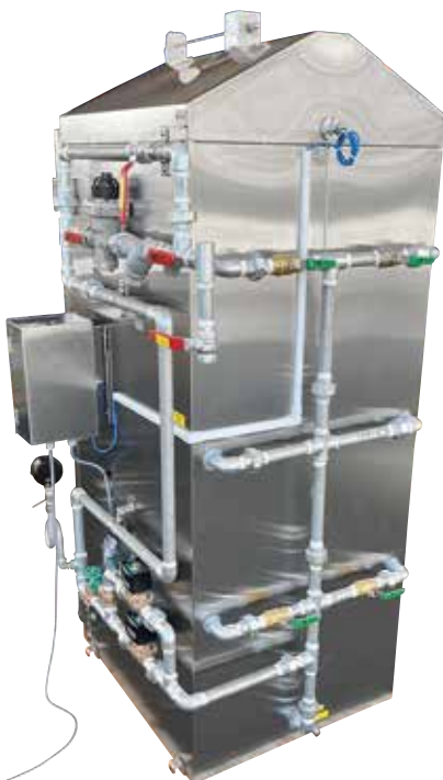
外配管のみスチール白管です
